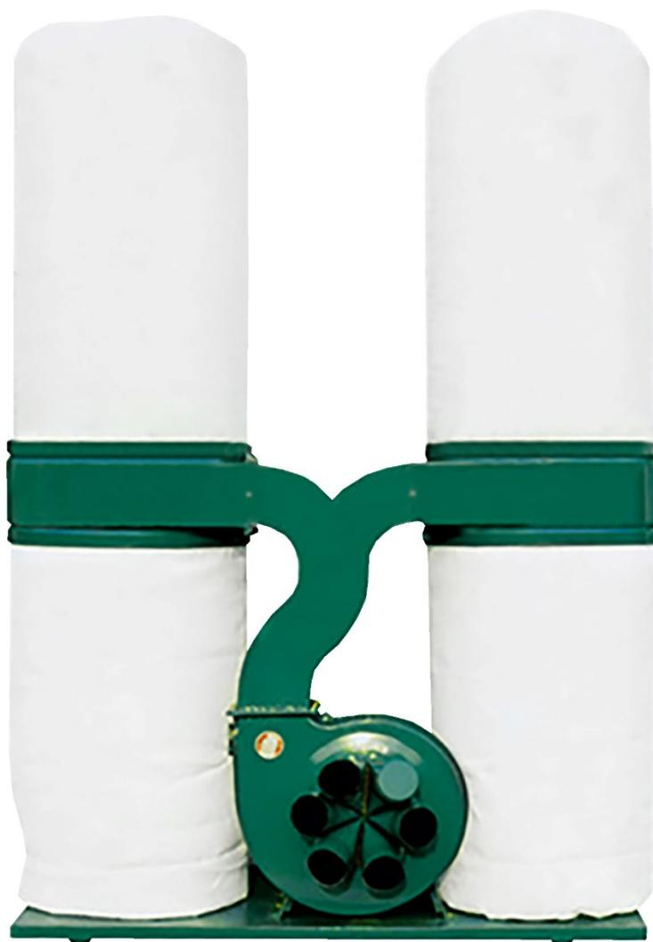
Пылеулавливающие агрегаты модели DM-7500C для очистки воздуха (удаление пыли, стружки, щепы) в зоне механической обработки деревообрабатывающих станков и с возможностью его возврата в производственные помещения.
